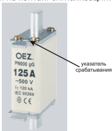
Указатель срабатывания ножевого предохранителя
